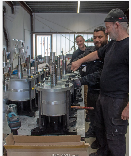
Montage von Pneumatik-Zylindern für die Schuhfabrikation bei GS-Systemtechnik
