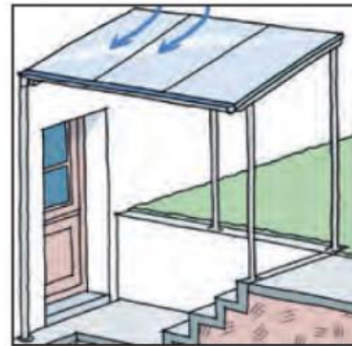
Abb. 28.8 Abschirmung durch Vordach
